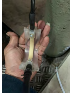
ก่อนทำความสะอาด ท่อรีดน้ำ ของ pump drain
