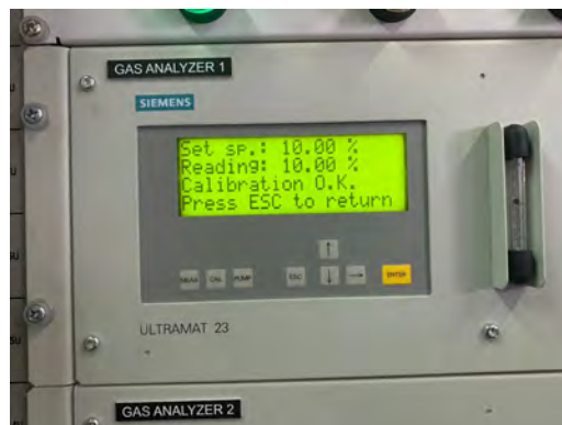
สอบเทียบ gas analyzer O2 หลังปรับเทียบ
