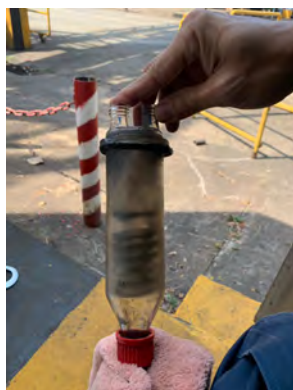
หลังทำความสะอาด chamber ของ cooler
