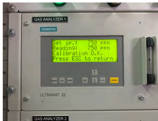
สอบเทียบ gas analyzer SO2 หลังปรับเทียบ
