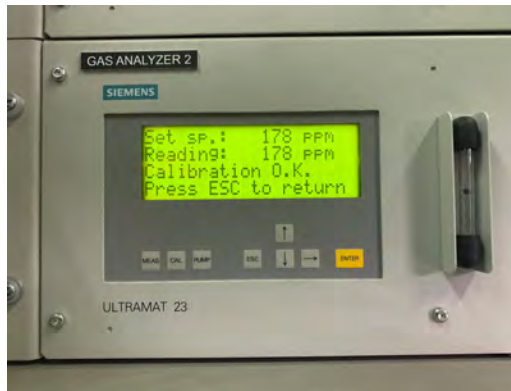
สอบเทียบ gas analyzer NO หลังปรับเทียบ
